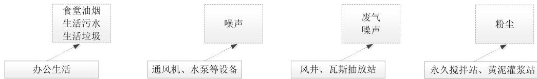
图 4.2-1 项目运营期工艺流程及产污环节
