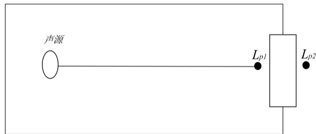
图 4-1 室内声源等效为室外声源的图例
