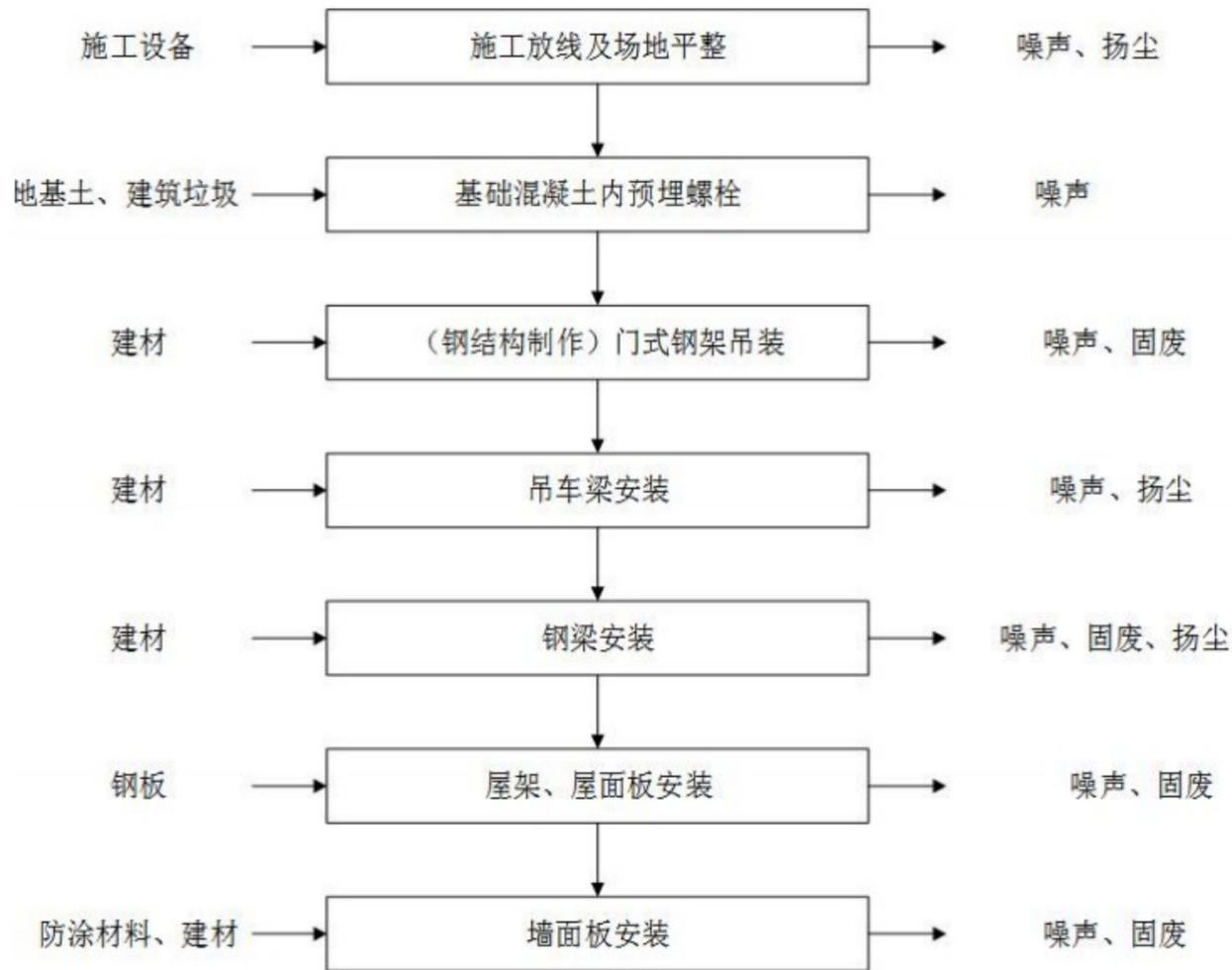
图 2-4 钢结构厂房建设工艺流程及产污环节图
