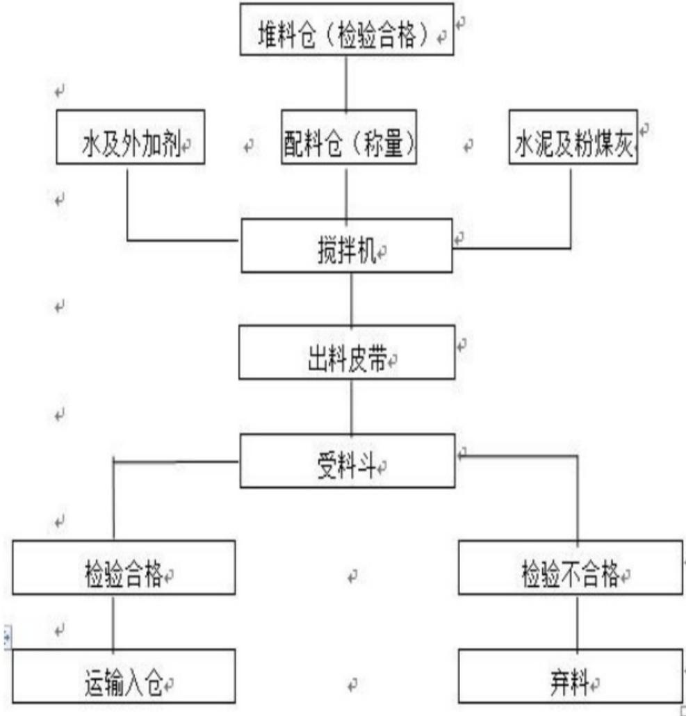
图 2-3 胶结料拌和系统工艺流程图
